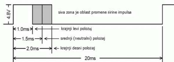
Sli 1. Izgled kontrolnog signala standardnog servo mehanizma.
