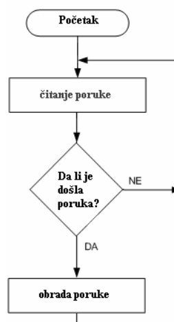
Sl.2. Sekvenca proveravanja novopristiglih poruka na nivou obrade poruka
