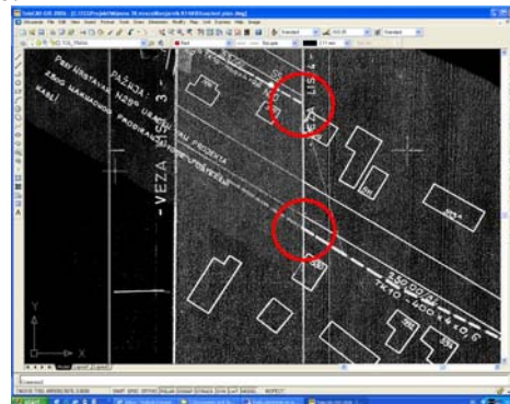
Sl. 3.7 Primer lošeg preklapanja kalibrisanih i georeferenciranih podloga
