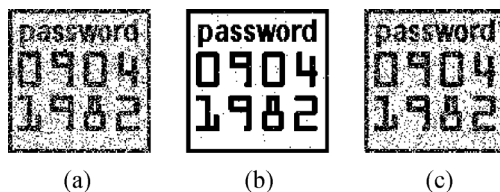
Sl. 5. Ekstraktovani DWM iz slike sa modifikovanim osvetljajem od (a) k = -30\% NC = 0,8658 (b) k = +10\% NC = 0,9971 (c) k = +30\% NC = 0,8852
