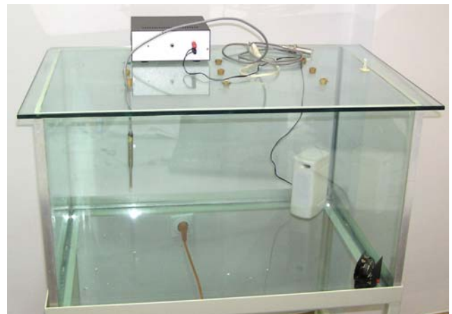
Slika 7 – Model paralelopipedne prostorije u razmeri 1:10 koji se koristi u nastavi za demonstriranje sopstvenih rezonanci prostorije
