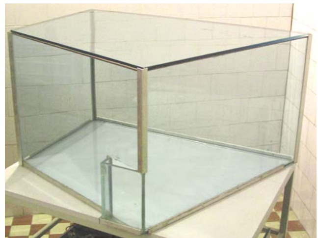
Slika 8 – Model reverberacione komore u razmeri 1:10 za merenja koeficijenta apsorpcije materijala koji se koriste za izradu modela
